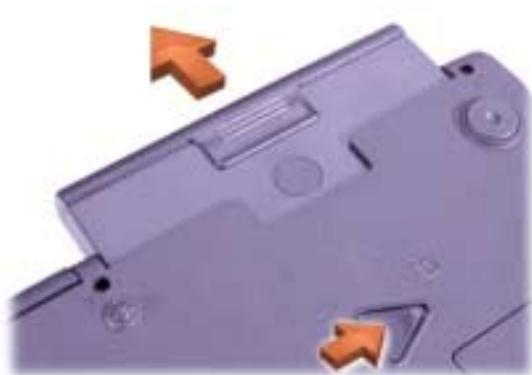
6 Csúsztassa be az új akkumulátort az akkumulátorrekeszbe. Egy kattanás jelzi, amikor az akkumulátor a helyére került.
